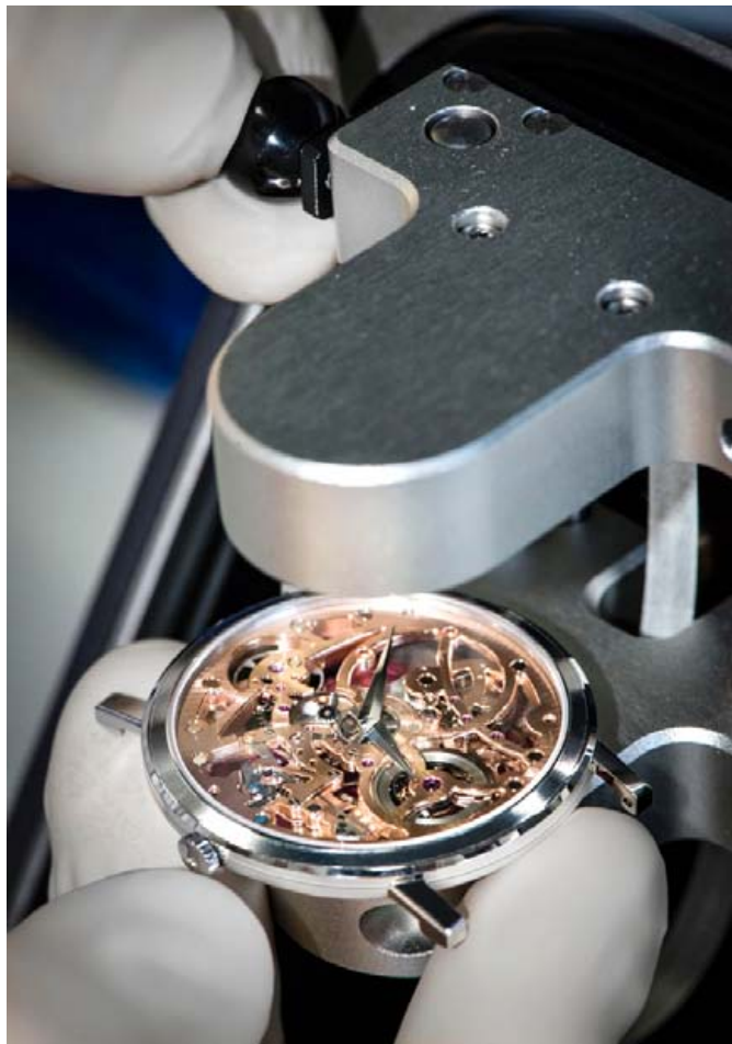
Linke Spalte: Die Höhe der Datumsbrücke wird nachgemessen, Überprüfen der Luftdichtigkeit (1200S); Rechte Spalte: Haute Horlogerie-Manufaktur Piaget in La Côte-aux-Fées, Atelier für Hand-Veredelungen und -Verzierungen, 1200P-Fertigung; Uhrwerksmontage.
