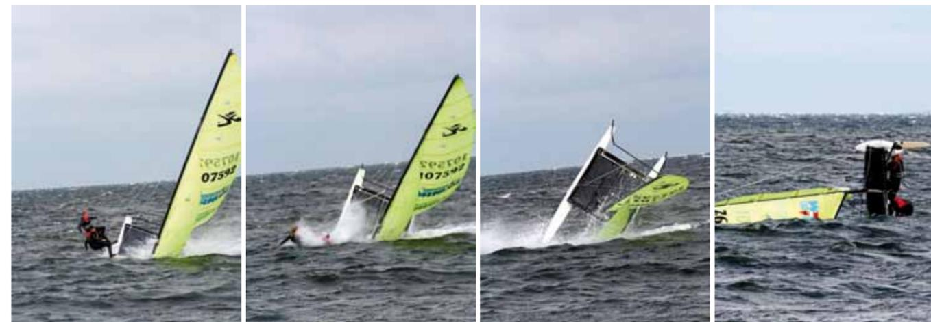
Die Bilderserie zeigt einen sogenannten »Stecker«. Hierbei tauchen die Rümpfe ins Wasser und das Boot kentert durch den Wasserwiderstand. Das letzte Bild der Serie zeigt das Wiederaufrichten des Bootes.
