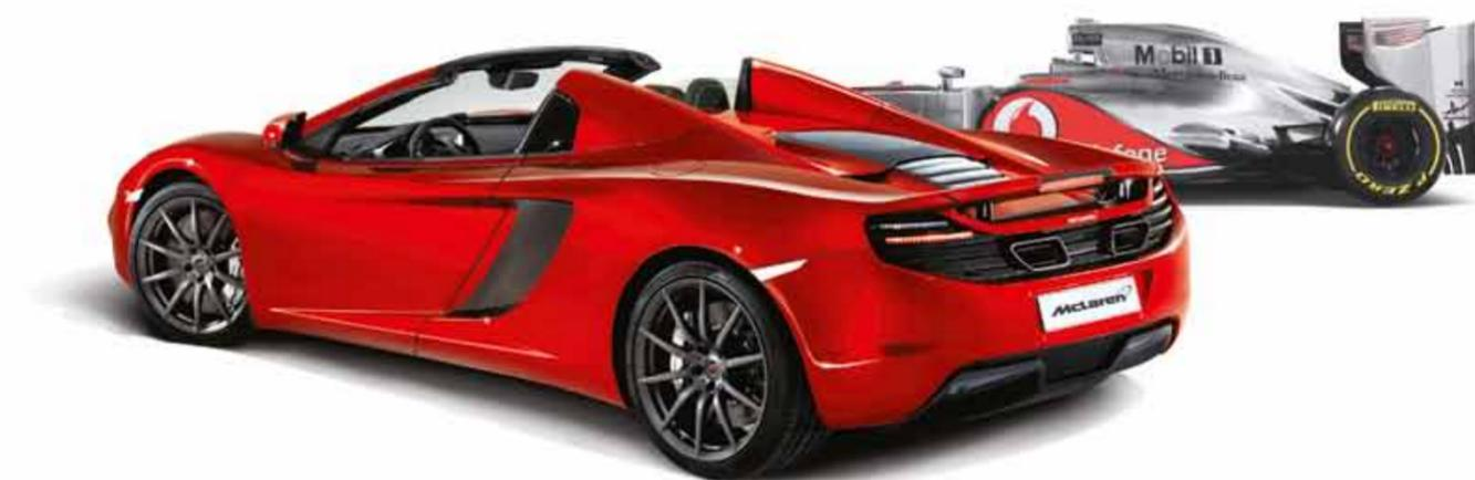
Wir haben eine perfekte Grundlage konsequent weiterentwickelt. Der 12C Spider besitzt das gleiche MonoCell-Kohlefaserchassis wie die Coupé-Version und benötigt deshalb keine herkömmlichen Verstärkungsstreben. Wir mussten lediglich sein elektrisch versenkbares Hardtop entwickeln.
